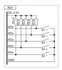
Номера входов I/O следует выбирать в диапазоне одного канала проса оператора – 1-15, 16-30, 31-34
