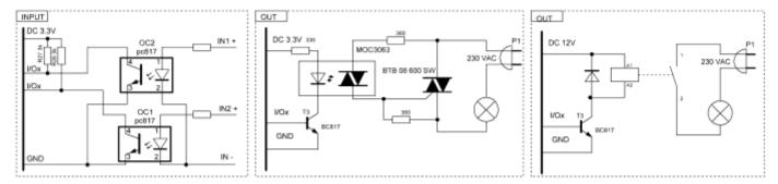
Управление из программы - используем оператор PORT Пример для подключения реле к I/O 4-7 с управлением от кнопок с предыдущего примера
