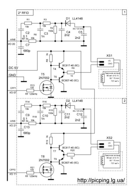
Представлена схема на 2 канала интерфейса RFID. Возможно использование каналов, как по отдельности, так и вместе.
