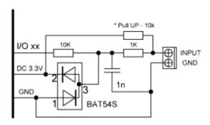
Типовая схема дискретного входа с защитой контроллера и общей землей.
