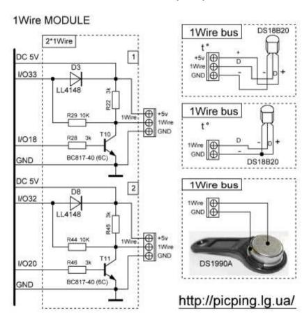
Представлена схема на 2 канала интерфейса 1Wire. Возможно использование каналов, как по отдельности, так и вместе.
